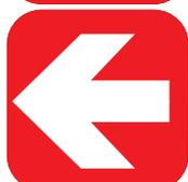
Cette flèche de direction montre le chemin vers un matériel de lutte contre l'incendie. Afin de ne pas être confondu avec la direction d'une issue de secours, il doit être accompagné d'un second pictogramme précisant la nature du dispositif de lutte.
