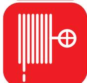
Ce signal permet de signaler la présence d'une lance à incendie, d'un dévidoir à alimentation axiale ou d'une armoire pour hydrant à alimentation axiale.
